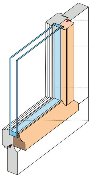
Dank der umlaufenden Dichtung auf der Wetterseite ist das Fenster wind- und schlagregendicht.
